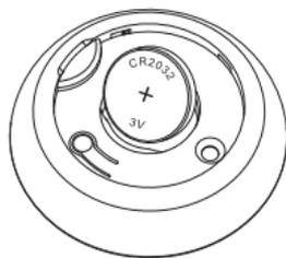
2. Installare la batteria come mostrato (CR2032 Le batterie devono essere acquistate separatamente)
