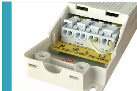
Di default, è presente un cavo collegato alle entrate L e L1. Questo significa che la modalità "luce permanente" è attiva. Per la modalità "luce non permanente" scollegare il cavo da L e L1. Modalità "non permanente" significa che la luce rimane spenta finchè non avviene un'interruzione di corrente.
