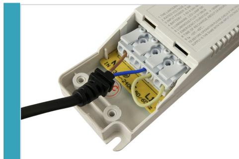
Collegare il cavo della rete elettrica 220V nelle entrate L de N. È possibile anche collegare un cavo di classe I per l'entrata della messa a terra.
