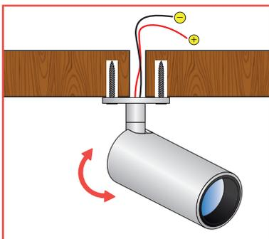
Praticare un foro di 8mm nella posizione prescelta. Fissare quindi il dispositivo sul piano d'appoggio.
