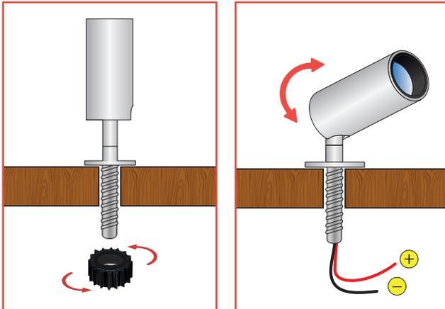
Praticare un foro di 8 millimetri sul piano di appoggio.
