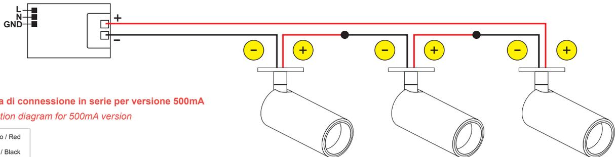
**Schema di connessione in serie per versione 500mA**
