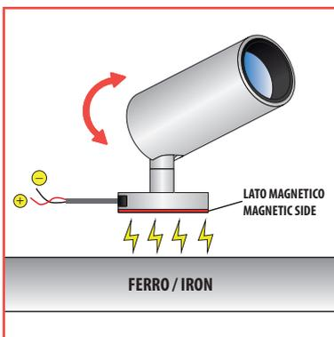
Posizionare il dispositivo nella posizione prescelta con il lato magnetico a contatto con il piano d'appoggio in ferro.
