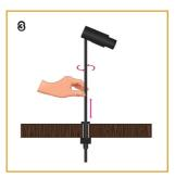
Praticare un foro di 12 millimetri sul piano di appoggio. Posizionare il tubetto filettato all'interno del foro praticato e bloccarlo al piano d'appoggio con l'apposita ghiera di fissaggio.
