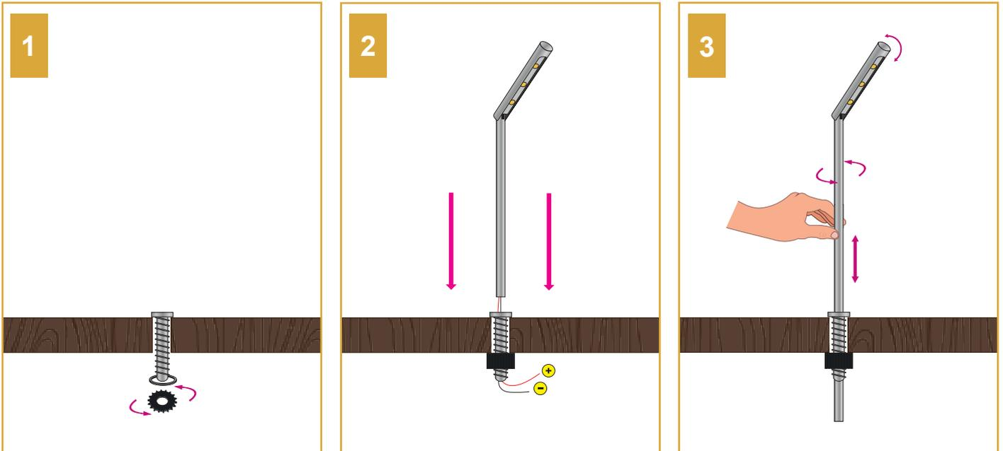
**1** Praticare un foro di 10 millimetri sul piano di appoggio. Posizionare il tubetto filettato all'interno del foro praticato e bloccarlo al piano d'appoggio con l'apposita ghiera di fissaggio.
