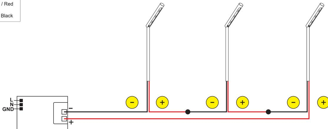
Schema di connessione in serie per versione 250mA / Connection diagram for 250mA version
