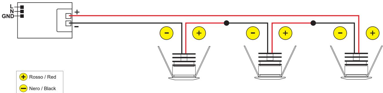
Schema di connessione in serie per versione 350 / 500 / 700mA - Connection diagram for 350 / 500 / 700mA version
