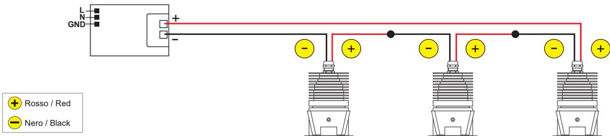
Schema di connessione in parallelo per versione 24V / Connection diagram for 24V version
