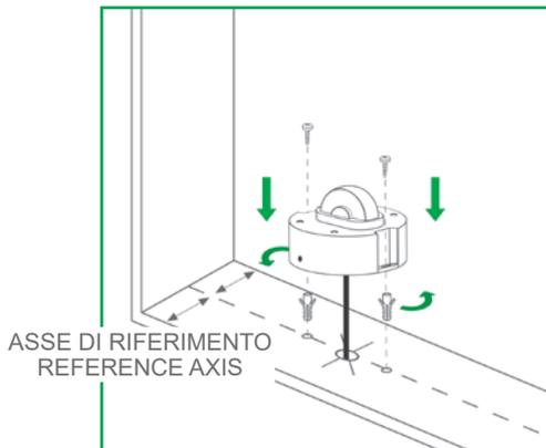
Praticare al centro dell'asse di riferimento un foro per il cavo e altri due laterali per le viti di fissaggio. A questo punto si potrà orientare l'apparecchio in base all'asse.
